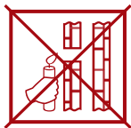
недостаточная тяга (Не используйте котел!)
